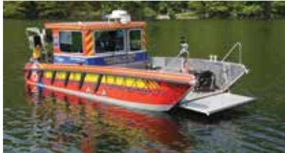
Boot mit abgesenkter Bugklappe
