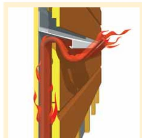
Bavette métallique pour éviter la propagation d'un incendie entre étages par la façade.
