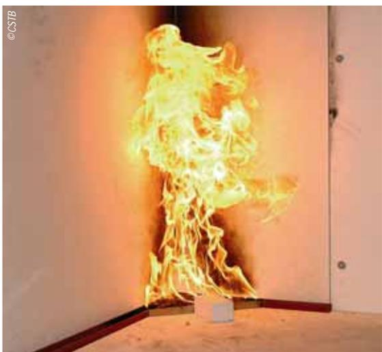
Mise en application du nouveau système d'essai européen de réaction au feu, SBI : Single Burning Item (EN 13823), réalisée dans les laboratoires du CSTB à Champs-sur-Marne.
